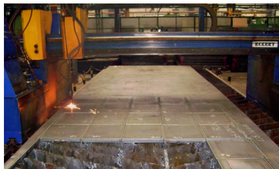
Obrysy cięte palnikiem CNC gas cut edges
