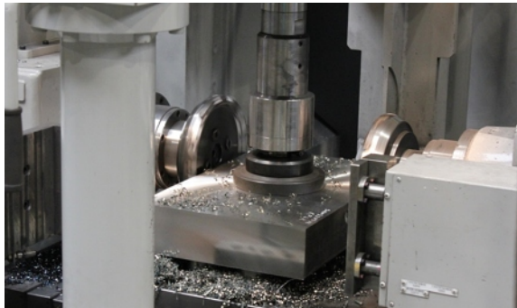
Obrysy frezowane Milled edges
