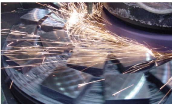
Płaszczyzny szlifowane planetarnie Surface planetary ground
